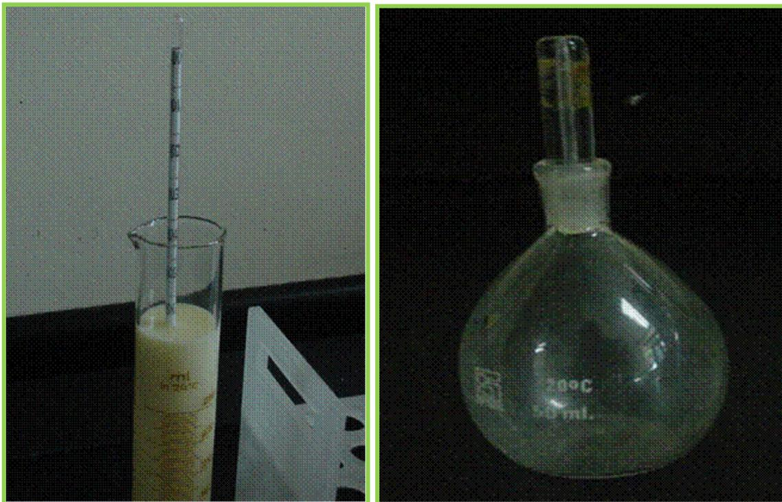
**Figura 4.** Picnómetro utilizado para la determinación de densidad (peso/volumen) en los calostros
