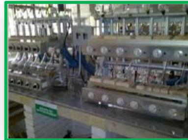
**Fotografía 10.** Determinación nitrógeno total y amoniacal.
