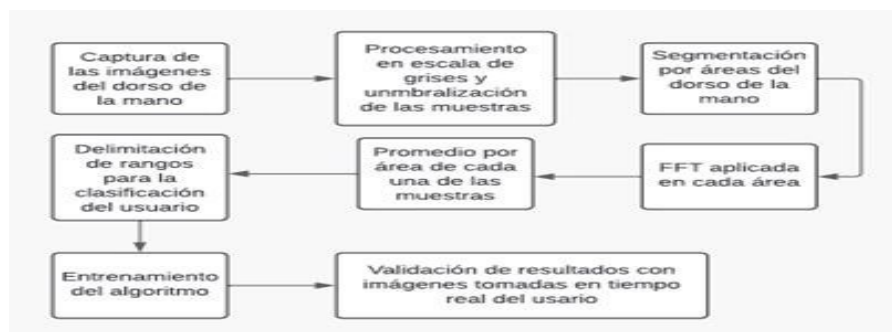
Fig .3. Diagrama de bloques del sistema biométrico
