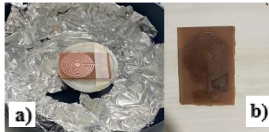
Fig. 4. Configuraciones del sensor de impedancia. Sea (a) Exitosa y (b) Errada.
