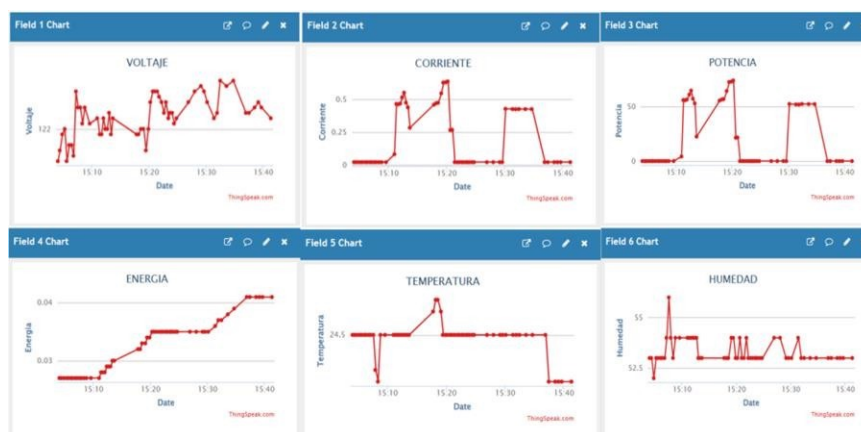
Fig. 3. Monitoreo de variables en plataforma IoT ThingSpeak.
