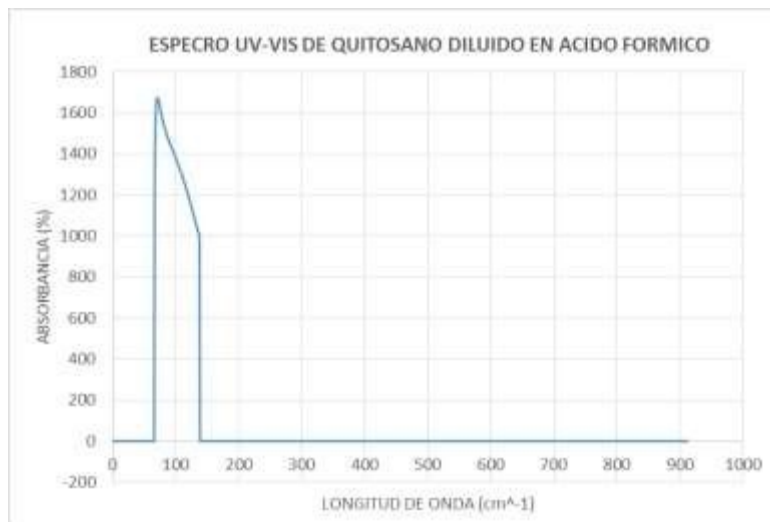
Imagen 1. Espectro UV-VIS quitosano diluido en ácido fórmico
