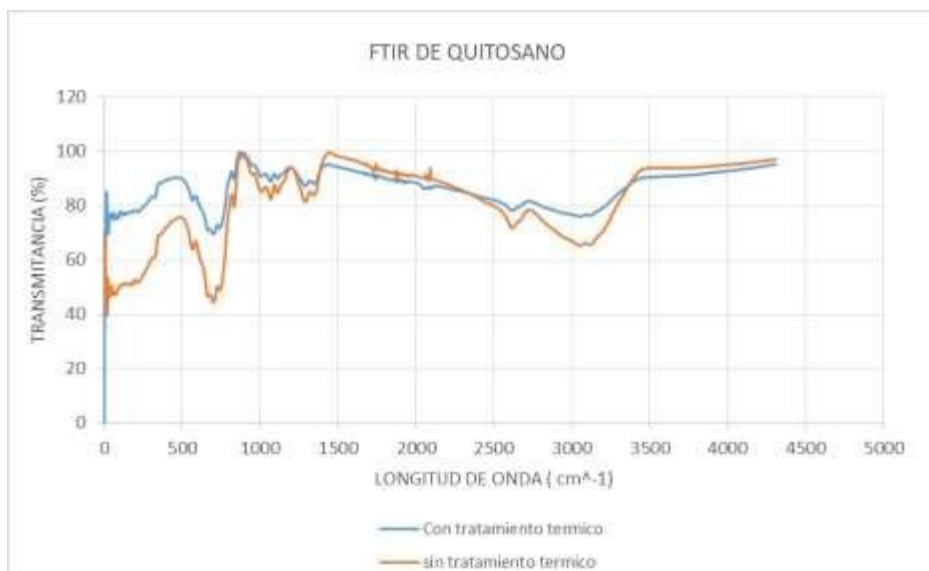
Imagen 2. Espectro FTIR con tratamiento térmico y sin tratamiento térmico
