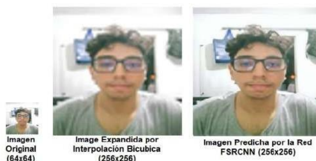
Fig. 2. Comparación de resolución espacial de la imagen original, escalamiento por interpolación bicúbica y generada por superresolución con la red neuronal.
