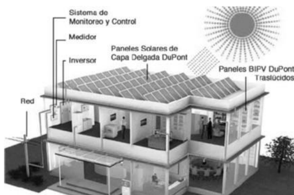
Fig. 2 Proceso energía solar fotovoltaica [7]
